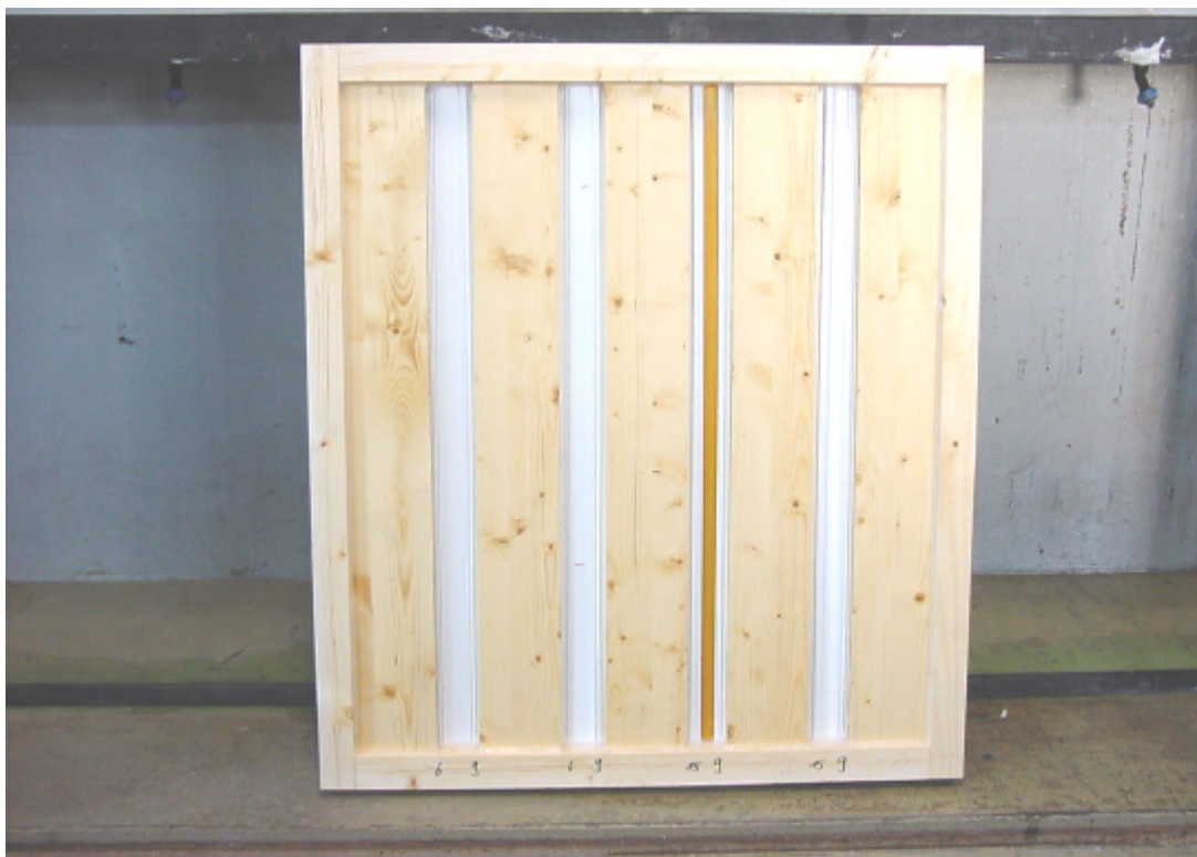
Bild 2 Prüfvorrichtung mit eingebauten Laibungsprofilen
