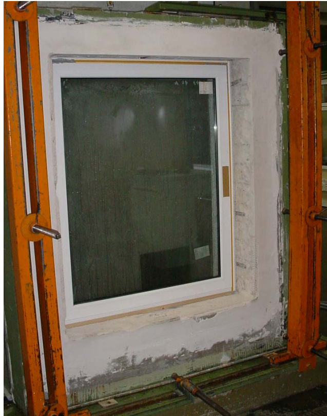
Bild 7 Probekörper auf dem Fensterprüfstand zur Prüfung der Schlagregendichtheit aufgebaut.
